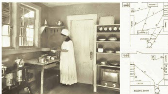
CHRISTINE FREDERICK, ama de casa Cocina-laboratorio. Planta de la cocina con los movimientos realizados en ella antes y después de organizarla según sus estudios (1913)
